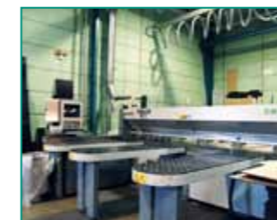
SELCO EB 95 sag (finér/tre/plast) 3,8 x 3,2m x 80mm med optimering
